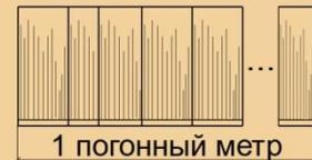
Например: Площадь кровли  $S=250$  кв.м. В качестве кровельного материала применяется шиндель длиной 40 см. Монтаж в три слоя. Шаг монтажа в этом случае составляет 125 мм или 0,125 метра.
